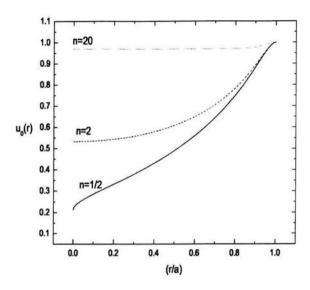
Figura 3.11: Perfiles de Velocidad de Flujo para l=30.
