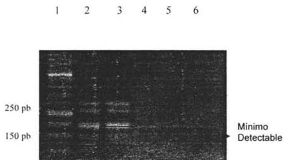
Figura 18. Productos de la amplificación del promotor 35S a partir de la dilución de Bt-11 al 0.002% y sus diluciones con agua en un gel de agarosa al 2%.
