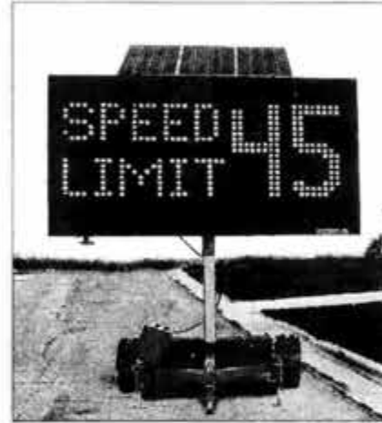
Señales móviles para trabajos de mantenimiento.
