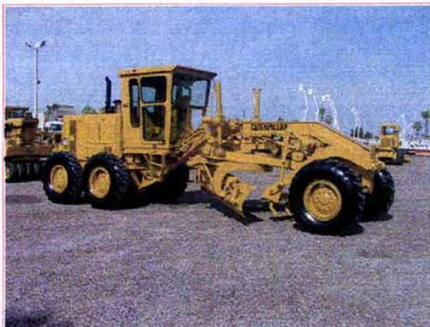
**Fig 5.5 Motoconformadora utilizada en el acamellonado, bandeado y tendido del material.**
