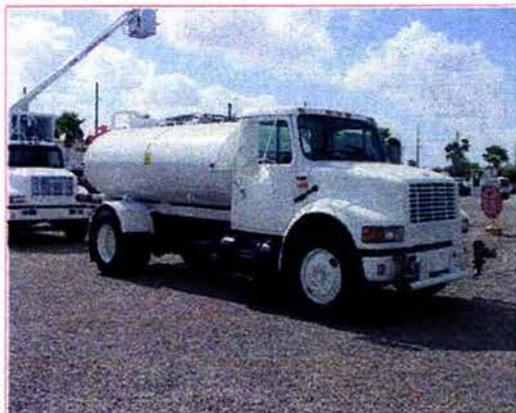
**Fig. 5.4 Pipa para transporte y acarreo de agua.**
