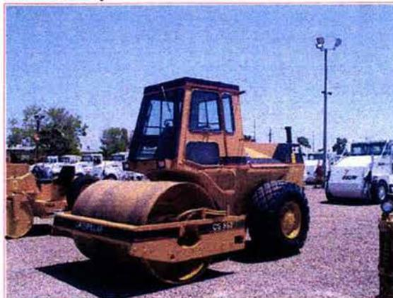
**Fig. 5.6 Vibrocompactador de rodillo liso utilizado en compactación de pavimentos (CCR).**
