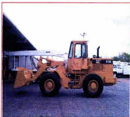
**Fig. 3.3 Cargador frontal sobre llantas para carga en banco de extracción de materiales pétreos.**
