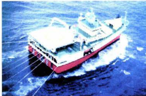
Figura 3.1 Embarcación Western Geco de levantamiento sísmológico continuo
