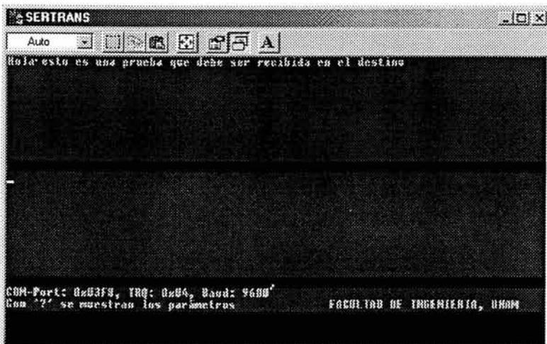
Figura 4.5 En esta figura se muestra el mensaje enviado visto en la estación receptora, el mensaje se recibe y se despliega en la zona "REMOTA" de la aplicación. El mensaje se va desplegando tal y como se va introduciendo del lado estación transmisora.
