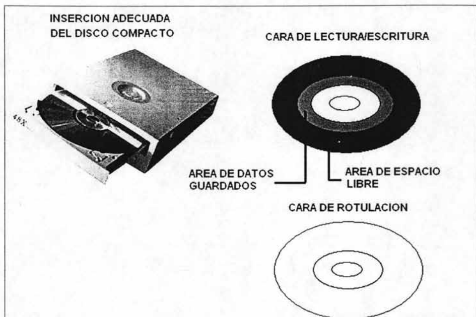
Figura 60. Bandeja de CD-ROM y Estructura del Disco. En algunos modelos de discos, la cara de lectura/escritura mantiene un color distintivo (generalmente plateado, dorado o azul), sin embargo, existen muchos otros cuyas ambas caras parecen similares, pero en una de ellas es posible verificar si contiene o no información de acuerdo al reconocimiento de una superficie concéntrica distintiva.
