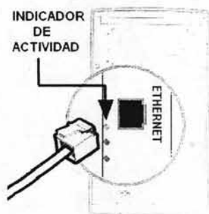
Figura 64. Conexión de la Tarjeta de Red.
