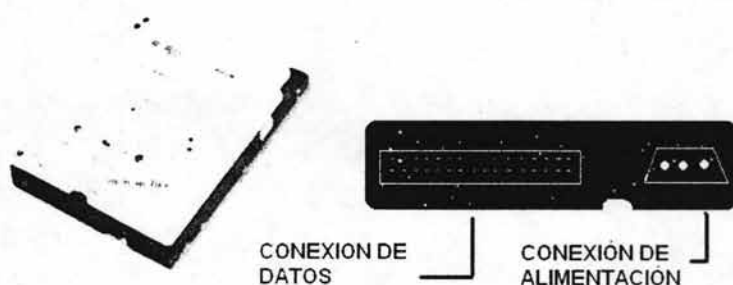
Figura 58. Disco Duro y Cara de sus Conectores.
