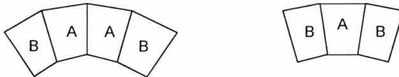
Figura 5.31. Ajuste del ángulo de cobertura de amplitud con 3 y 4 arreglos de bocinas
