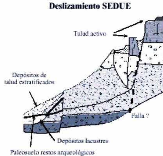
Figura VIII. 3 Sección del deslizamiento SEDUE
