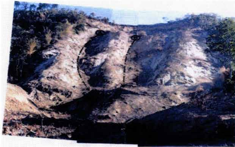
Figura VIII. 23 Deslizamiento en la ladera "Las Colinas". Apréciase la acumulación al pie de arenas limosas muy sueltas
