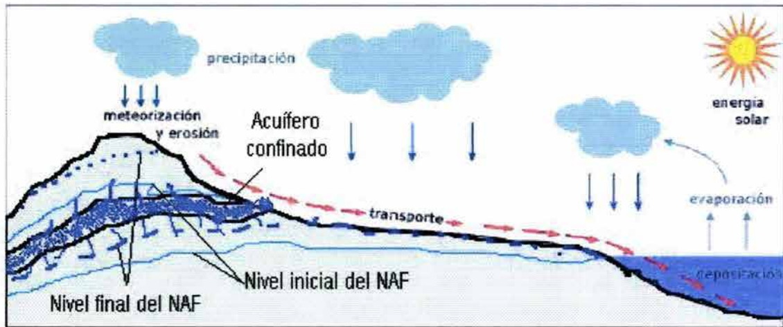
Ilustración 49 Ciclo hidrológico incidiendo en una masa rocosa.
