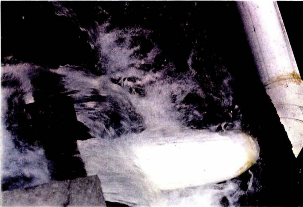
FOTO 4. Detalle de la tubería alimentadora del modelo
