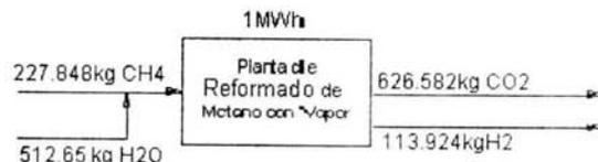
**Figura 4.7. Balance de masas para 1MWh, utilizando un reactor nuclear para suministrar la energía requerida para el proceso de reformado de vapor con metano.**
