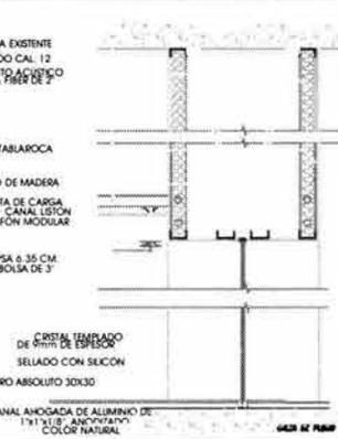
09 ESCALA 1:20 FUJO DE CRISTAL (DETALLE DE SUJECIÓN)
