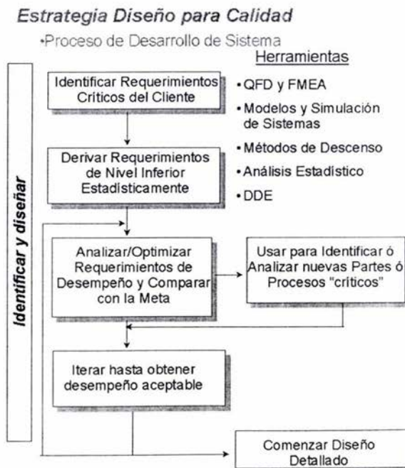
Figura 7.4. Diagrama de flujo para cumplir con los pasos de identificación (paso 1) y diseño (paso 2) [3].
