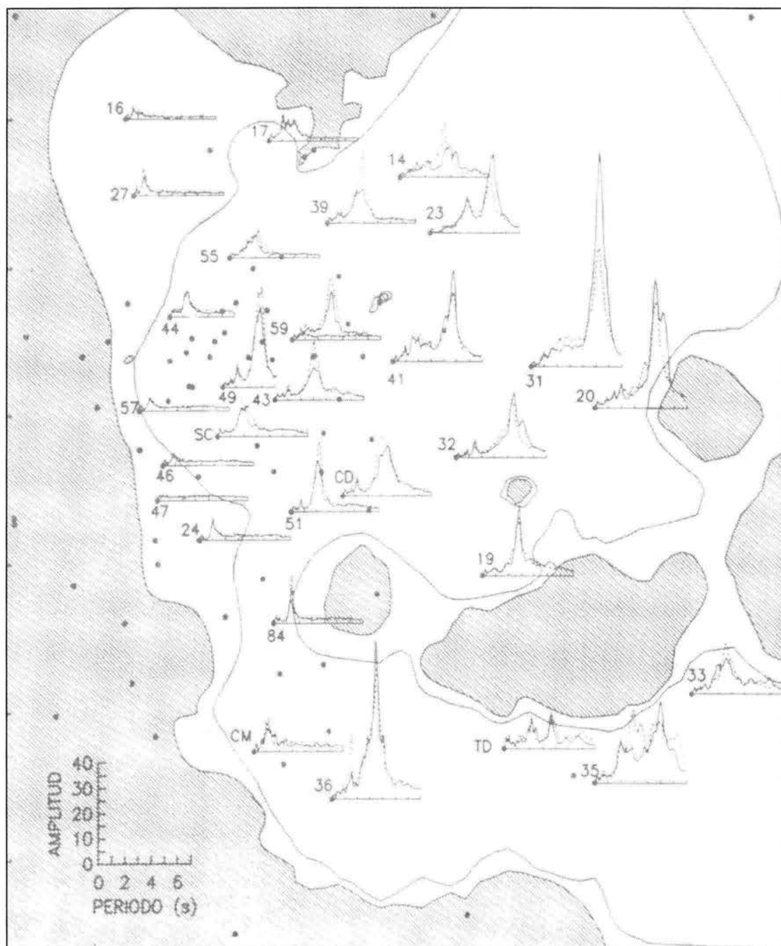
Figura 25. Mapa de cocientes espectrales representativos para la Ciudad de México, datos de sismos (Reinoso y Ordaz, 1997).
