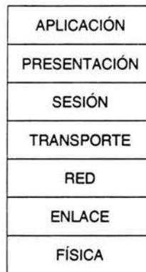
Figura 4.1. Capas del modelo OSI.
