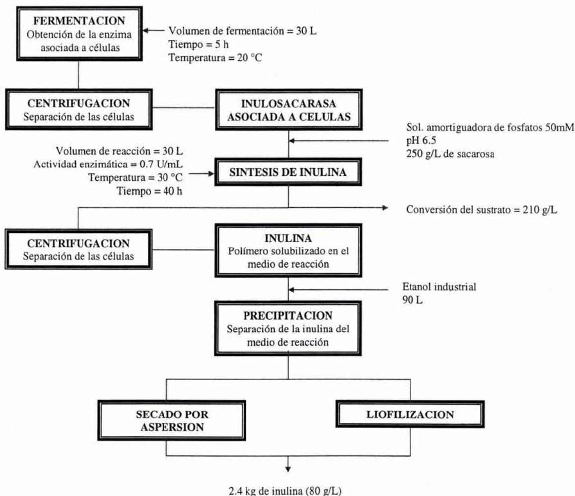
Figura 17. Diagrama de la producción de inulina en la planta piloto.
