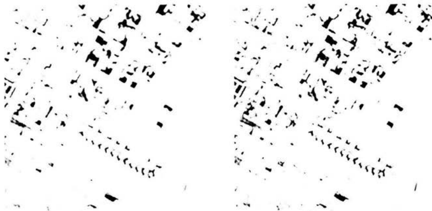
(a) (b) Figura 7-77 Descriptor de Correlación: (a) v=7 \times 7 , d=3 (b) v=5 \times 5 , d=2 .
