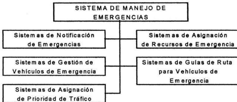
Figura 38. Componentes de los Sistemas de Manejo de Emergencias.
