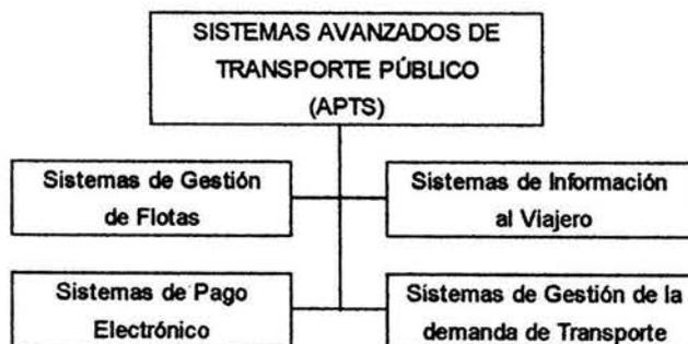
Figura 22. Estructuración de los APTS.
