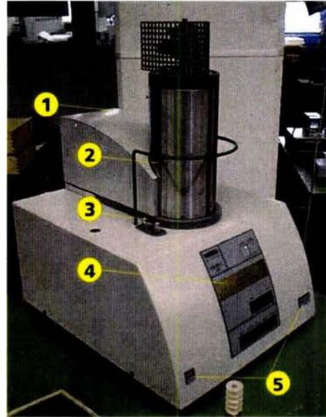
Equipo NETZSCH STA 449 C Júpiter. (1) Brazo para posición del horno. (2) Horno. (3) Válvulas para flujo de gases. (4) Display y panel de funciones. (5) Botones para funcionamiento del brazo.
