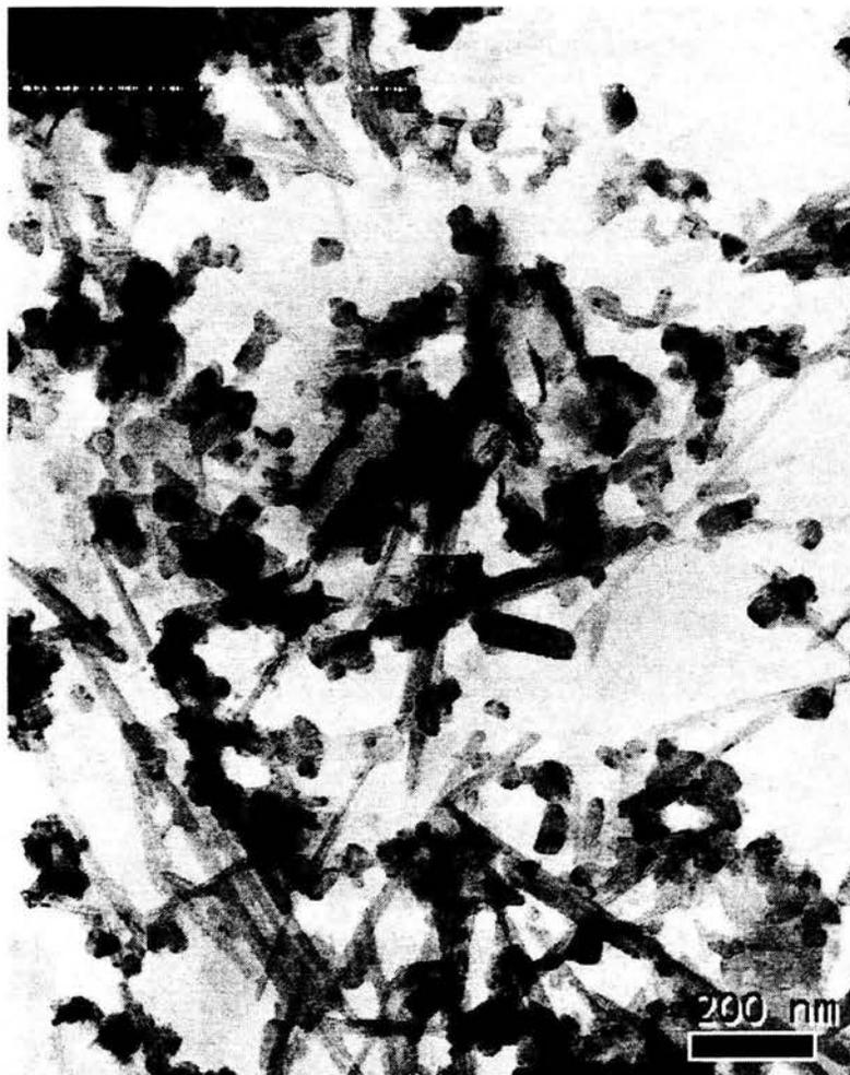
*Figura 4.27 Micrografía de nanotubos oxidados, tratada con ácido nítrico, se observa que los nanotubos están más separados uno de otro y las partículas de carbono amorfo y grafito oxidadas.*
