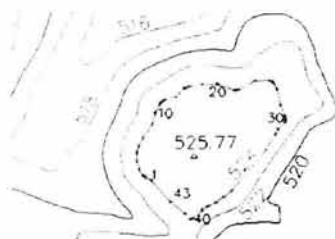
Fig. 2.8.3 Obtención de las coordenadas X, Y, Z de los puntos del terreno original
