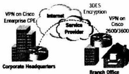
Figura 6.5 Conectividad Punto a Punto con el uso de ruteadores
