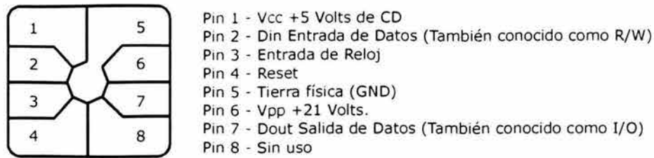
Figura 5.12 Asignación de los contactos en la tarjeta telefónica
