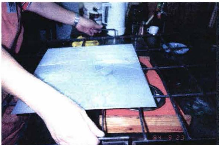
mucho cuidado la placa con la capa de resina -¡Cuidado con el viento!-, y se pone sobre el calor. Mover la placa constantemente, sin parar, permite que la placa no se pandee.
