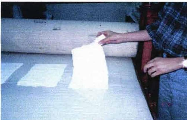
Una vez fijada la presión del tórculo, la placa ya entintada y limpios sus biseles, se coloca sobre la platina; usando las uñas –para no ensuciar el papel-, se acomoda el papel sobre la placa. Se cubre con el papel filtro húmedo –o con
