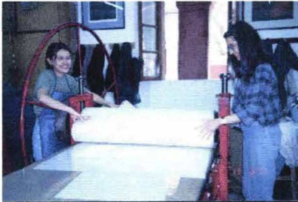
Se levantan los fieltros, y con las uñas de papel se alza una esquina del papel impreso para revisar si la presión fue suficiente, o si requiere una nueva pasada del rodillo del tórculo. \*De hecho, este procedimiento es por si fallara el tórculo; en condiciones
