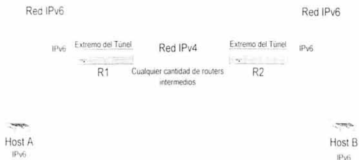
Figura 4.1: El funcionamiento de los túneles
