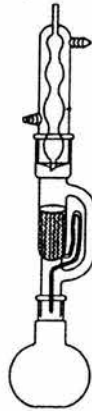
Figura 2. Equipo soxhlet para extracción con Diclorometano en preparación de filtro de Ze- Flúor para monitoreo de PM_{2.5} )
