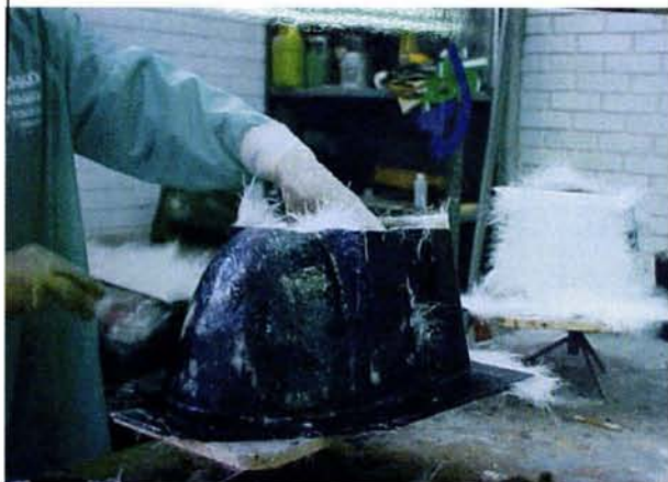
Fabricación de molde de fibra de vidrio para realizar en cemento un modelo de taza para letrina seca de DESICA.
