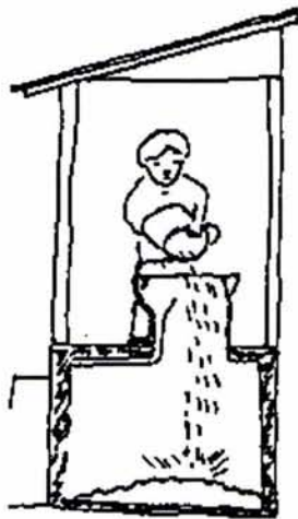
Letrina seca comunitaria diseñada por el Ing. Jean Fritche para el medio rural dentro del grupo DESICA
