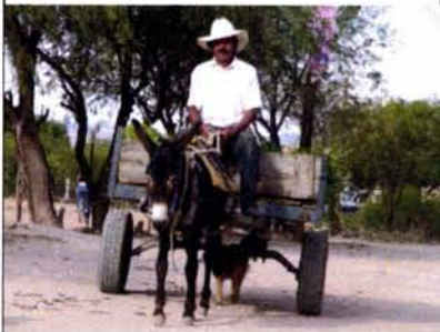
Volanda construida con ejes de automóvil.
