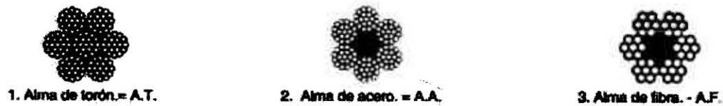
**Fig. 3.2.6 Secciones y tipos de torones**
