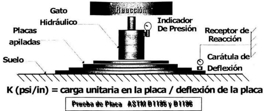
Figura 1.13. Prueba de placa ASTM D 1195 y 1196
