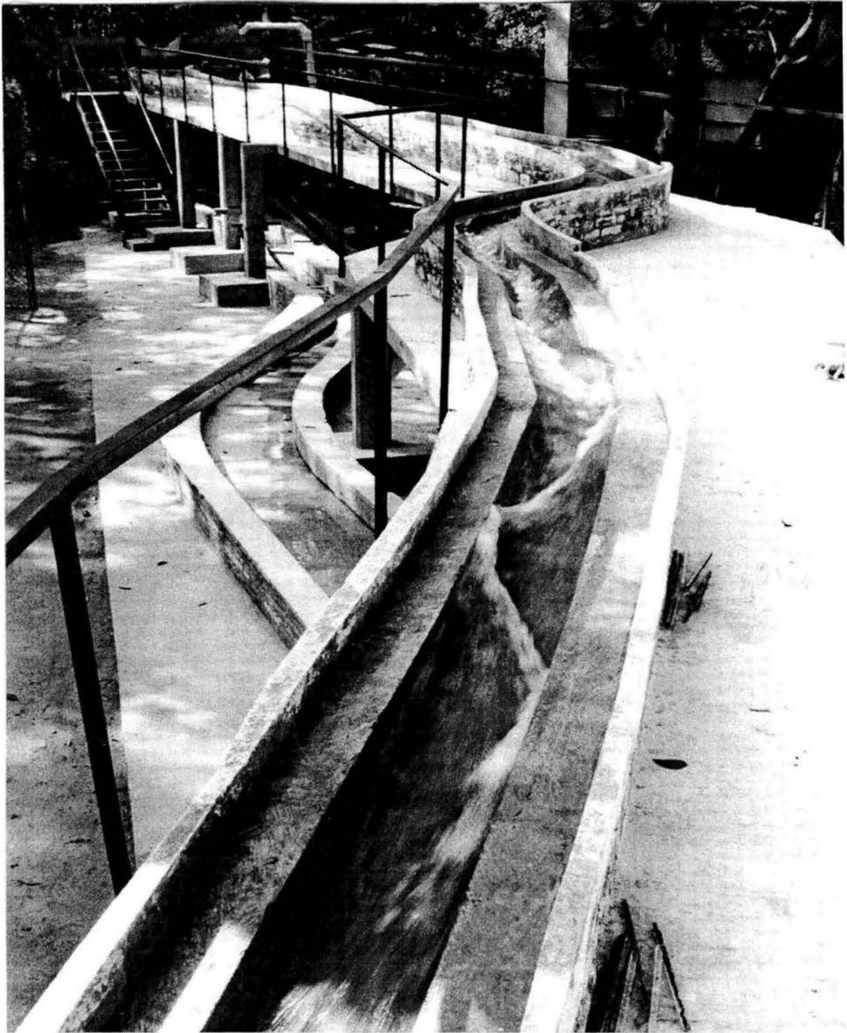
Foto 6.2 Tránsito de la avenida extraordinaria en el modelo del encauzamiento del arroyo Allende, afluente del río Motozintla, Chiapas.
