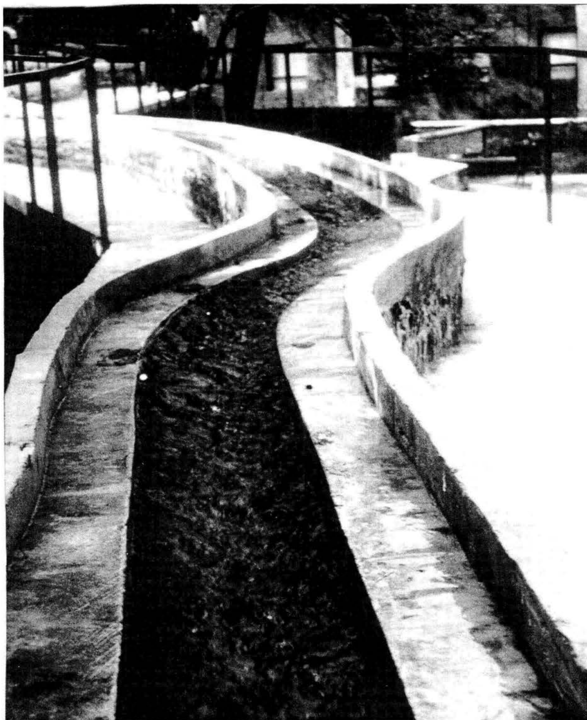
Foto 6.3 Tránsito de la avenida en el modelo del encauzamiento del arroyo Allende, afluente del río Motozintla, Chiapas, con rugosidad artificial de fondo.
