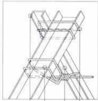
SISTEMA DE SUSPENSION ARMADO CON ALAMBRE GALVANIZADO No. 18 COMO SE REQUERA
