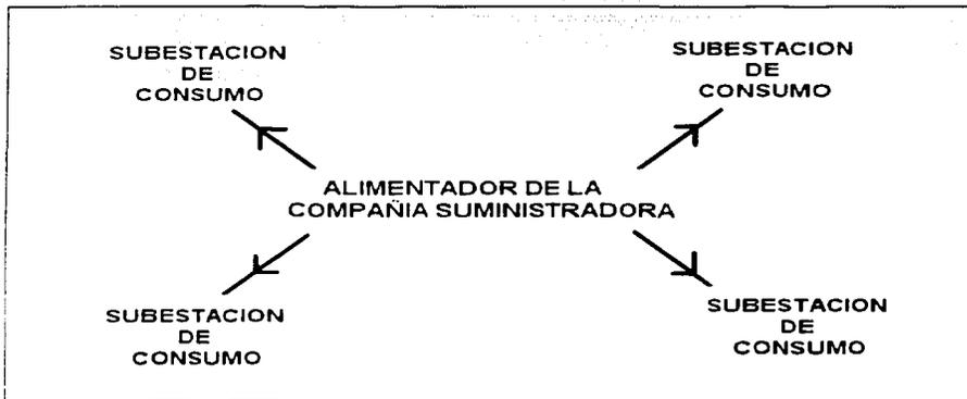
Figura 8 . Sistema de distribución radial (simple).
