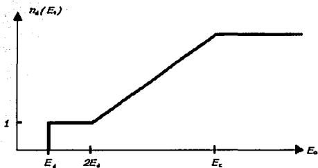
Fig. 1.12 Propuesta de Kinchin y Pense sobre el número de desplazamientos producidos en una cascada de iones.
