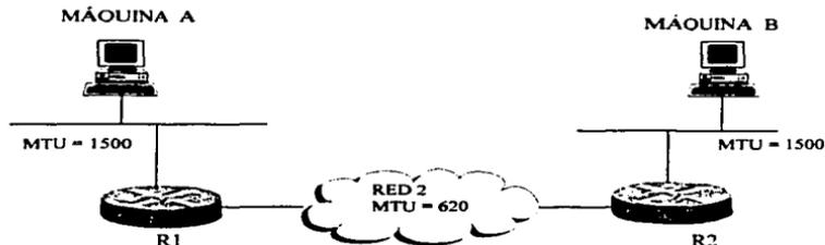
Figura 2.4 Fragmentación de una trama Ethernet.
