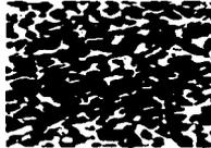
Fig. 1.5.4 Microestructura del acero al carbono, cristales oscuros de perlita
