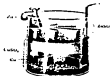
Figura II.1.- Pila de Daniell.
