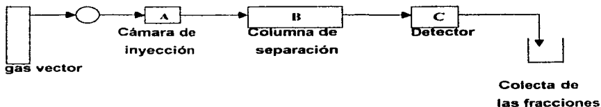
Figura 2. Esquema simplificado de un aparato de cromatografía en fase gaseosa. ( 37 )
