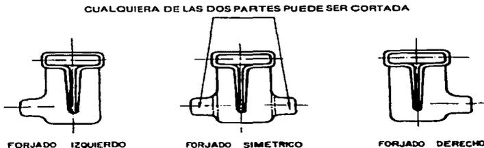
**Figura 2.29** Una forja simétrica puede ser económica, especialmente si después de maquinada la parte opuesta, la pieza resulta ser casi simétrica
