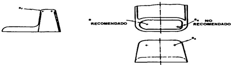
**Figura 2.17** En los extremos de un nervio se recomienda un redondeamiento completo
