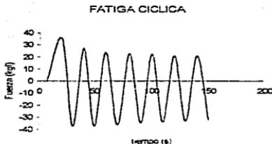
Figura 1.2 Curva representativa de una prueba de fatiga cíclica (Bourne, 1978).
