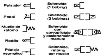
Además del método de accionamiento también debe tenerse en cuenta el método de reposición. Un ejemplo es la válvula que utiliza un solenoide como medio de accionamiento y un muelle de retorno para regresar a su posición inicial o de partida.
