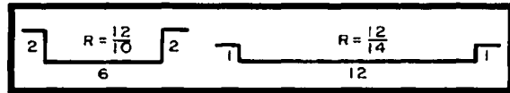
Figura 4.54. Canales con un área idéntica de sección transversal con radios hidráulicos diferentes.
