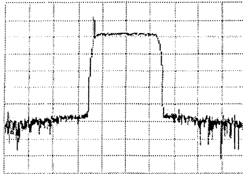
Figura 6.6 Espectro en frecuencia de RF 8-VSB.
