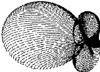
Figura 3.6 Patrón de radiación tridimensional de una antena Yagi.
