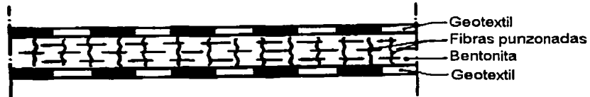
Fig. 2.4 Geotextil con bentonita (Koerner et al, 1995)
