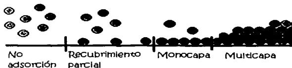
Figura 4.4. Representación esquemática de la adsorción de un gas en un sólido.
