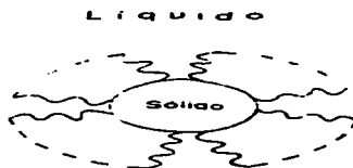
Figura 11.- Esquema del modelo de la doble capa propuesto por Nedich y Kildsig para explicar el proceso de disolución. Se forman corrientes de moléculas disueltas del soluto, las cuales viajan a través del disolvente, a semejanza de un sólido poroso, oponiéndose hasta cierta distancia, una barrera para el avance de las moléculas de soluto hacia el seno del líquido.
