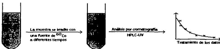
Figura 12. Diseño experimental para determinar la radiólisis de adenina libre en solución acuosa
