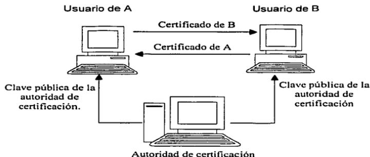
Figura V.3 Esquema general de autenticación mediante certificados de clave pública
