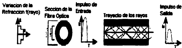
Figura 2.15. Fibra Óptica Multimodo de Índice Gradual
