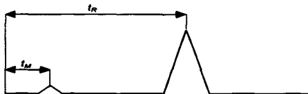
Figura 2. Esquema de un cromatograma mostrando los parámetros que determinan el factor de retención.
