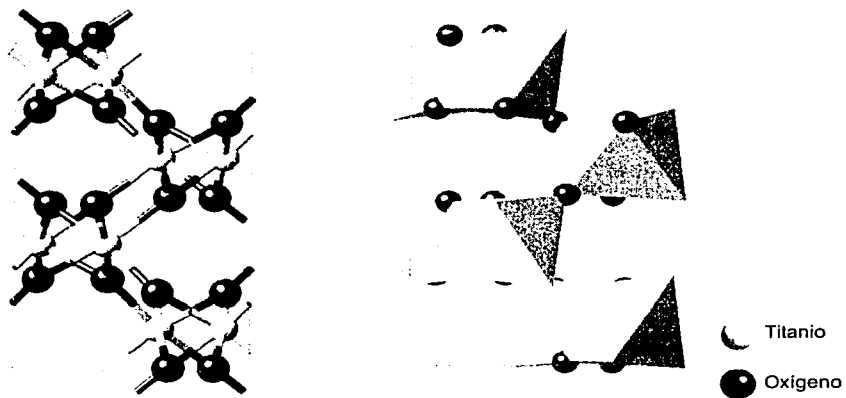
Figura 11.3. Estructura cristalina y poliedro de coordinación de la brookita ( \text{TiO}_2 ).
